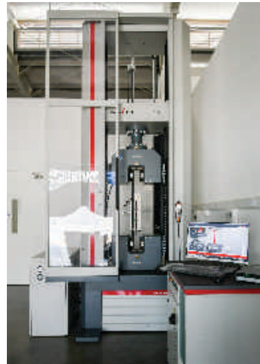
◀ आकृति 34. संरचनात्मक अभियांत्रिकी प्रयोगशाला में उच्च क्षमता वाले इलेक्ट्रो-मैकेनिकल यूटीएम
