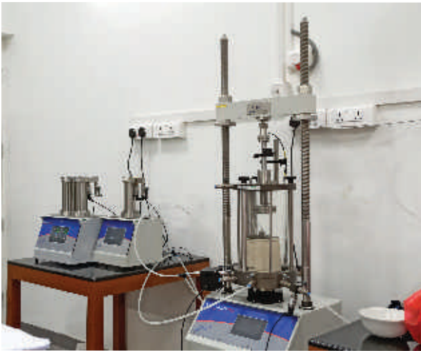
▲ आकृति 45. पारगम्यता माप के साथ स्वचालित तनाव-पथ स्थिर त्रिपक्षीय उपकरण
